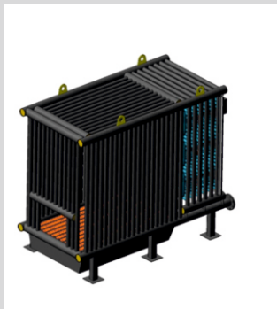
Рисунок 1.3 - трубная часть котла KBr (визуализация).
