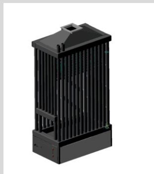
Рисунок 2.1 - трубная часть котла КВр-0,1 (визуализация).
