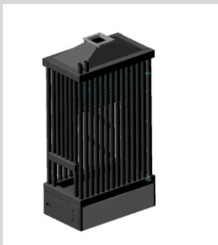
Рисунок 1.1 - трубная часть котла KBr-0,1 (визуализация).
