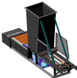
Рисунок 5.3 - Топка механическая с шурующей планкой ТМУ (визуализация)
